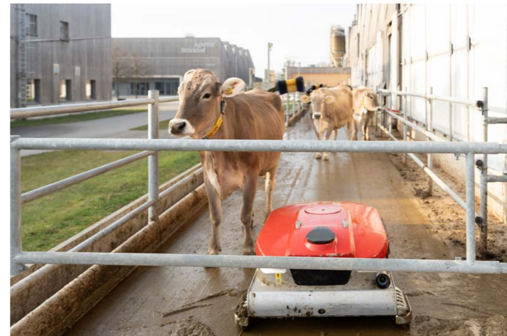
Saugroboter nehmen Kot und Harn direkt in integrierte Tanks auf.
