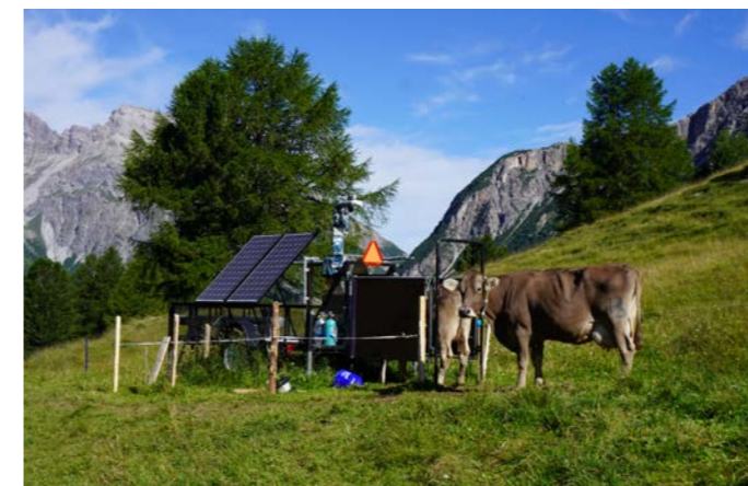
Der mobile Weidemelkstand ermöglicht das Melken direkt auf der Weide auch bei wechselnden Standorten.
