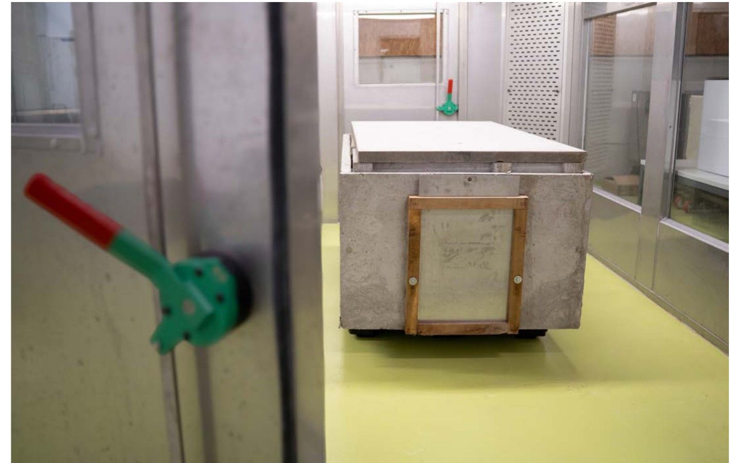
Verschiedene Stallböden und deren Oberflächen werden in den Respirationskammern getestet.
