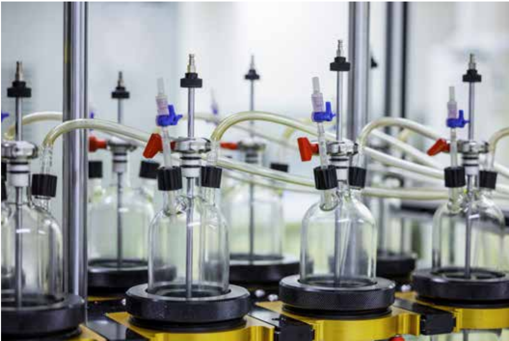
Rusitec: Laborsystem zur kontinuierlichen Simulation der mikrobiellen Verdauung im Pansen unter kontrollierten Bedingungen.
