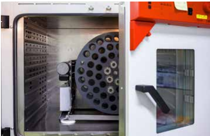
Hohenheimer Futterwerttest (HFT): Standardisierte Methode zur quantitativen Erfassung der Gasbildung bei der mikrobiellen Umsetzung von Futtermitteln.
