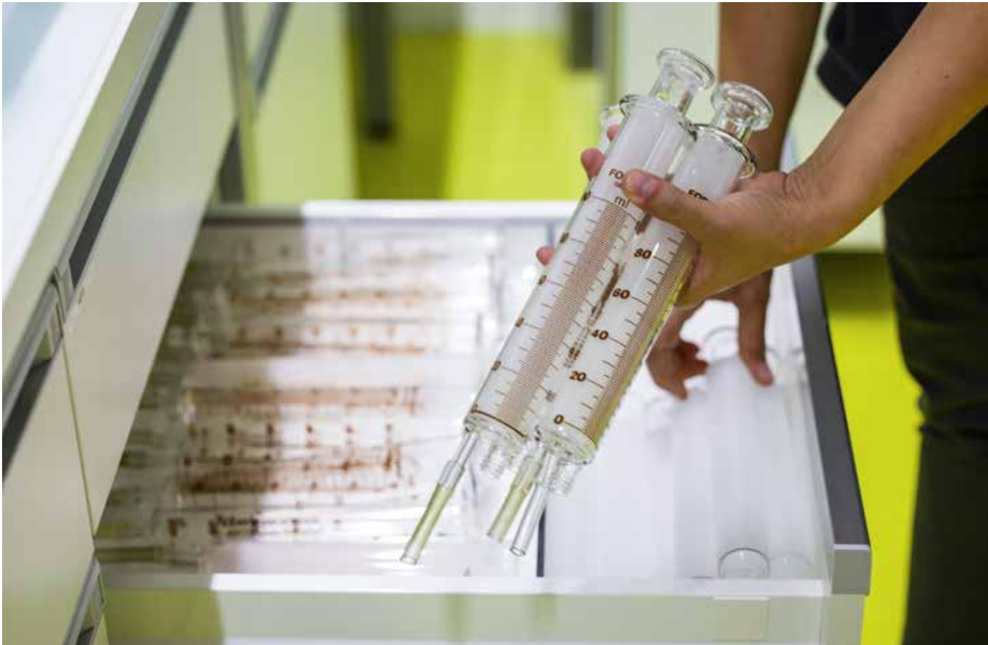
Hohenheimer Futterwerttest (HFT): Standardisierte Methode zur quantitativen Erfassung der Gasbildung bei der mikrobiellen Umsetzung von Futtermitteln.
